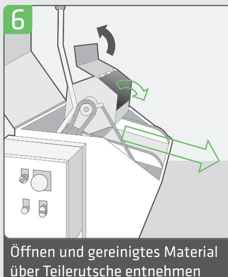
Die Waschtrommel wird mit bis zu 25 kg öligen Teilen beladen – diese läuft im Kaltreinigerbad – wodurch alle Teile gründlich gespült und gereinigt werden. Trommel nun mit Hilfe des Kipphebels ins Kaltreinigerbad senken. Spüldauer und Trommelgeschwindigkeit können optional eingestellt werden, um empfindliche Teile ohne Beschädigungen zu reinigen.
